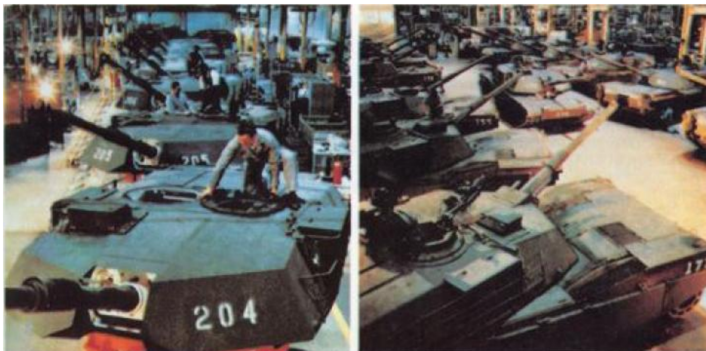
СБОРОЧНАЯ ЛИНИЯ ТАНКА М-1 «АБРАМС» на реконструированном танковом заводе в г. Лайма (штат Огайо). Производственные мощности завода 1200 танков в год. Всего в бронетанковой промышленности США более 15 сборочных заводов.
